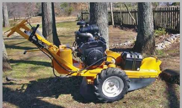
Il sistema di avanzamento idrostatico consente la variazione continua della velocità permettendo una precisione millimetrica del movimento.
