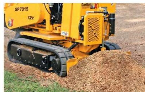
Il controllo idraulico della lama livellatrice permette di pulire il luogo di lavoro e aumenta la visibilità sul ceppo.
