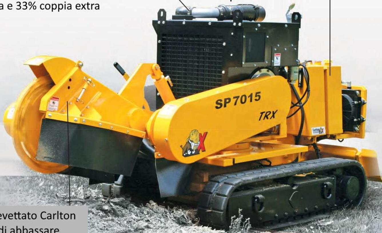
Il disco brevettato Carlton permette di abbassare il baricentro della macchina, avere un motore molto stabile posto orizzontalmente durante il lavoro.
