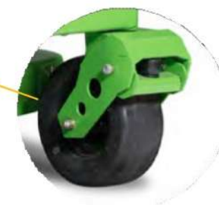
RUOTE ANTERIORI ANTI FORATURA SOSPENSIONE (opzionale)
