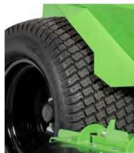
RUOTE POSTERIORI DA PRATO O RUOTE SENZ'ARIA MICHELIN X TWEELS®
